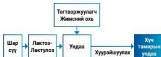
Зураг 1. Шар сүүг боловсруулж бүтээгдэхүүн үйлдвэрлэх схем
